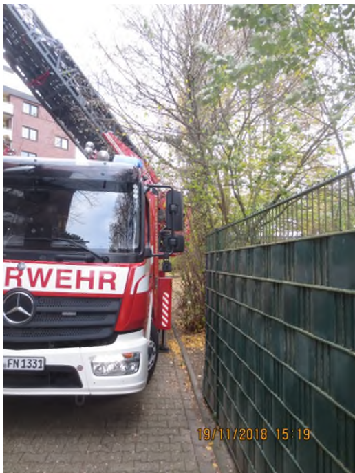
Bsp. 9.4: kein freier Geländestreifen vorhanden; der Leiterpark kann nicht ausschwenken! Der freie Geländestreifen muss mindestens eine Breite von 2 m aufweisen!
