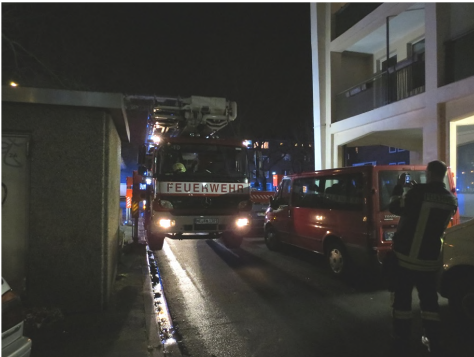
Bsp. 9.8.2: unzureichende Aufstellfläche im Brandeinsatz
