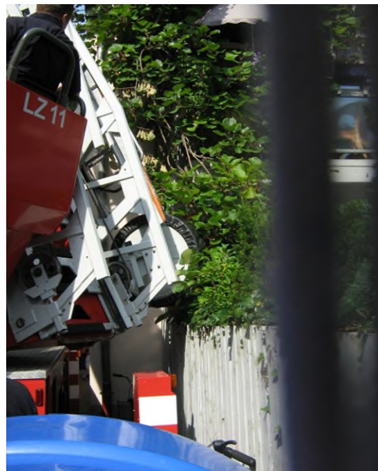
Bsp. 9.4: kein freier Geländestreifen vorhanden; der Leiterpark kann nicht ausschwenken! Der freie Geländestreifen muss mindestens eine Breite von 2 m aufweisen!
