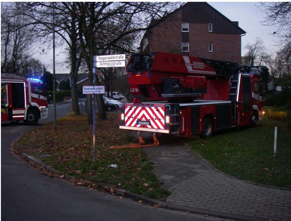
Bsp. 9.4: Schotterrassen wird von der Feuerwehr Neuss nicht zugelassen
