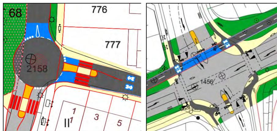
*Abbildung 2-8: Knotenpunkte mit unterschiedlichen Verlustzeiten: (Mini-)Kreisverkehr und Signalanlagen*
