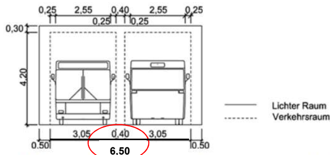
Bild 15: Grundmaße für Verkehrsräume und lichte Räume von Linienbussen mit maximaler Fahrzeugbreite (W = 2,55 m)
