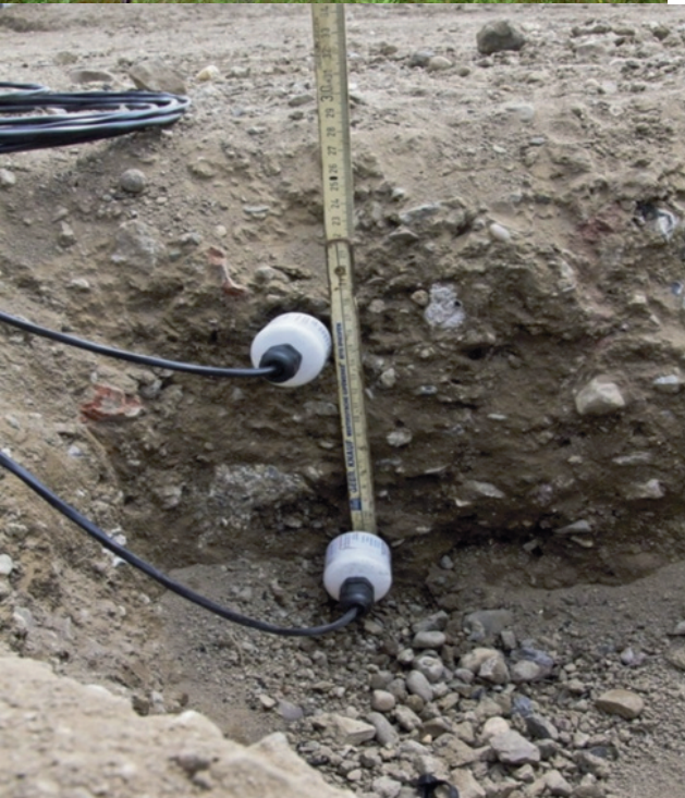
Bodenprofil Hafengelände Neuss mit Messsensoren für Bodenfeuchte/-temperatur
